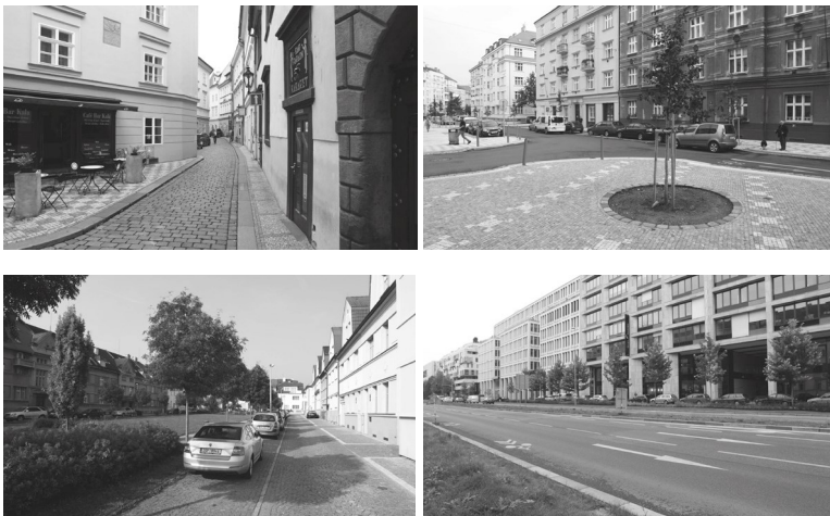
[ obr. 14 ] Uzavřená stavební čára Příklady: historické rostlé město (Staré Město), struktura činžovních domů 19. století (Dejvice), zahradní čtvrť (Hanspaulka), současná zástavba (Karlín)
